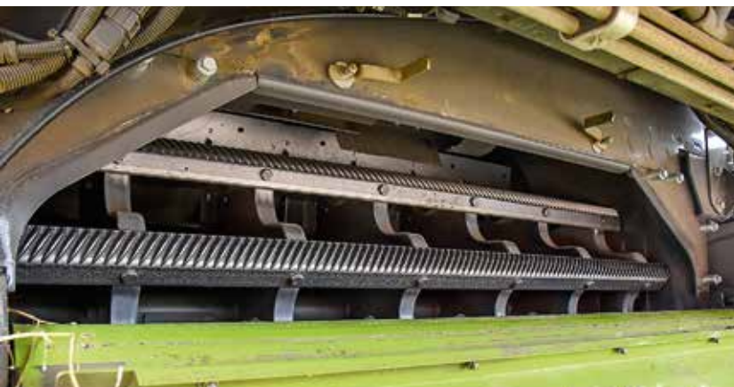
◁ Der offene Dreschkorb des Evion hat einen Durchmesser von 600 mm. Der Dreschkanal ist 1,42 m breit.
